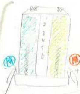
電解質として硫酸ナトリウムを入れる！ ( $\text{Na}_2\text{SO}_4$ )
